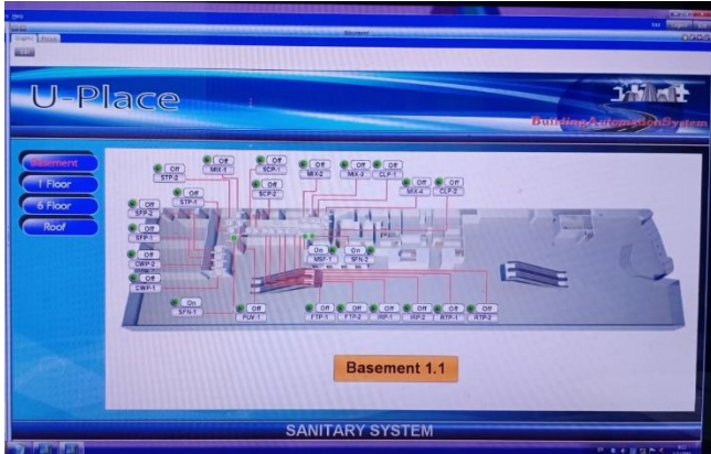
ระบบควบคุมปั๊มน้ำอัตโนมัติ
